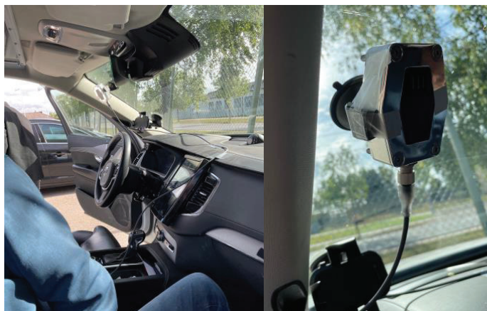
Figur 7: Placering av radarsensor vid mätning av förarens hjärtfrekvens.
