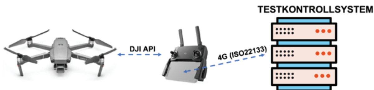
Figur 17 – Drönarkommunikation med testkontrollsystemet
