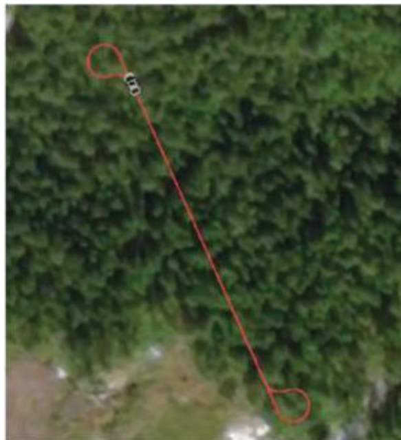
Figur 11 – Bilder från det grafiska gränssnittet efter att ett prov har blivit utfört och ska till att köra tillbaka testobjektet. Till vänster visas den trajektoria som precis har körts och till höger visas en trajektoria innehållandes "the Williamson turn" som genererats av testkontrollsystemet för att ta testobjektet tillbaka till sin startposition.
