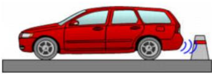
Figur 6: PA systemets sensorer detekterar och varnar för objekt vid parkering.
