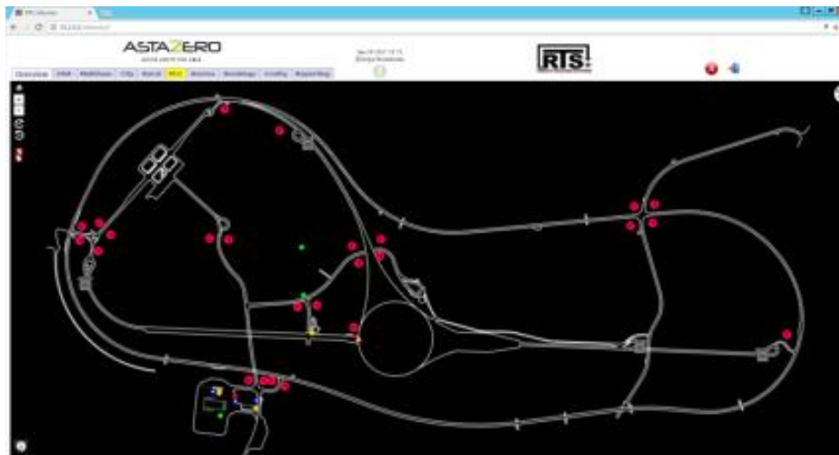
Figur 1, bild på trafikledningssystemet på AstaZero där gröna och gula punkter är fordon och röda punkter illustrerar vägbommar.
