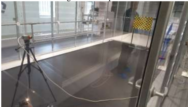
Figur 1 visar SWIR-målet uppställt i vindtunneln på mittuniversitetet redo för prov.
