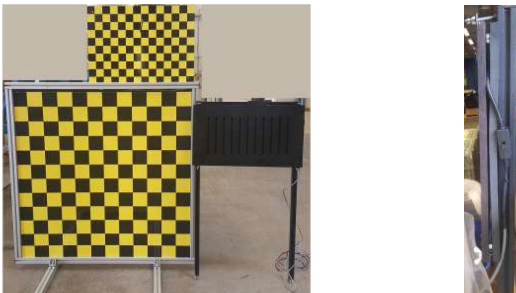
Figur 3 till vänster visas de tre olika målen: överst är 50x50mm SWIR-mål, till vänster är 100x100mm SWIR-mål och till höger är LWIR-målet. Till höger visas LWIR-målet från sidan där man kan se de olika skikten.
