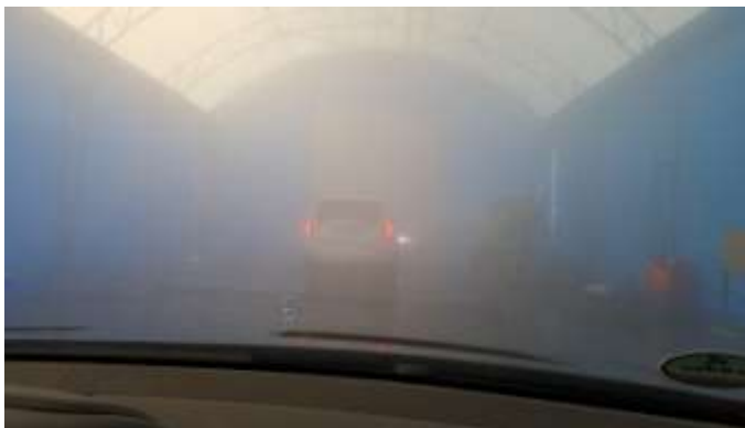
Figur 6 Visar den andra bilen sett inifrån provbilen då snökanonen varit aktiv i 4 minuter för att skapa dimma.
