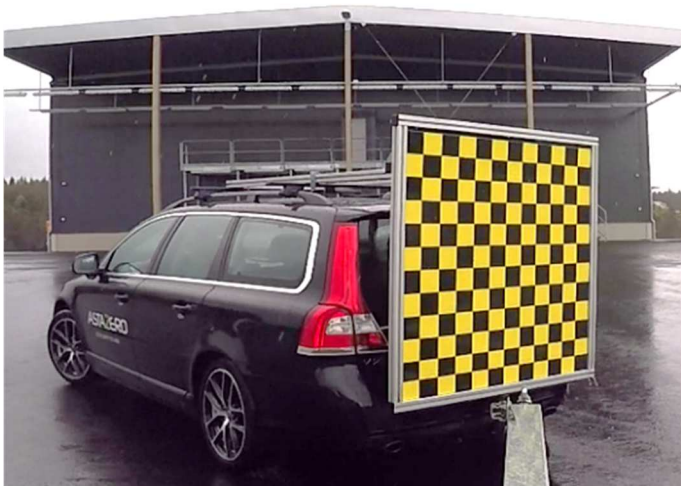
Figur 1 Gridmodulen monterad på AstaZeros Volvo V70. Skärmen sitter på dragkroken och en adapter möjliggör att SV-Trailer också kopplas till dragkroken.
