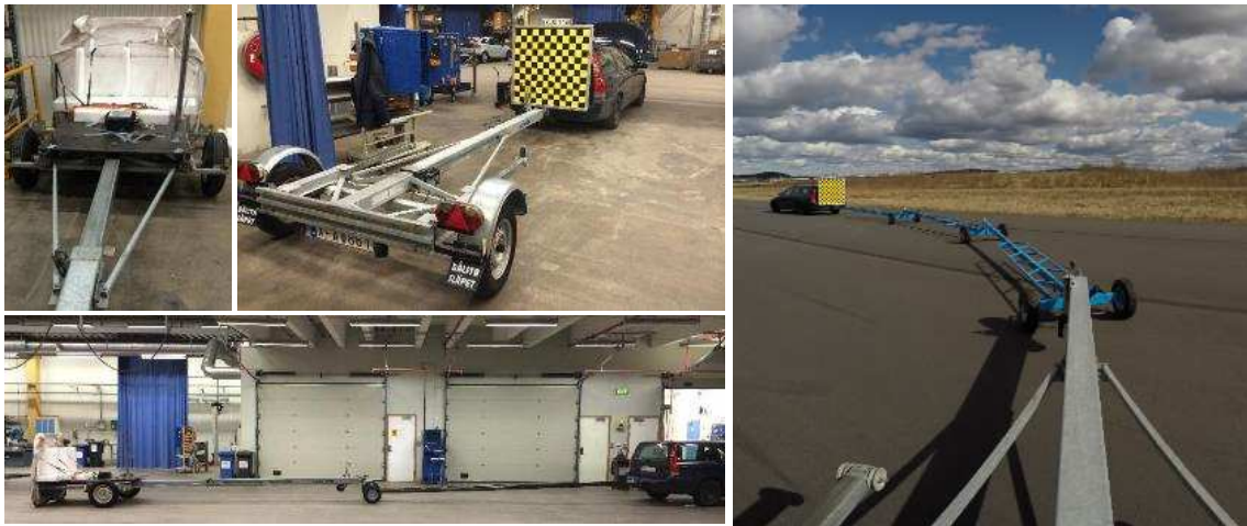
Figur 2 På SV-Trailer konstruerades hållare för kameror och sensorer för provning. De tre distansvagnarna gav möjlighet att filma gridmodulen med stabilt och exakt avstånd på 5/11/17/23 meter mellan POV och SV-Trailern
