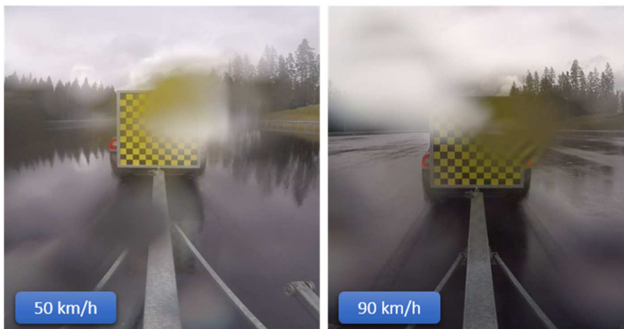
Figur 7 Prov med SV-Trailer på AstaZeros höghastighetsyta påvisade vattenspray men i betydligt mindre omfattning än på vanligt asfaltsunderlag såsom vid landsvägsproverna eller på Vårgårda flygfält. Omsättningen av droppar på skärmen var högre vid 90 km/h
