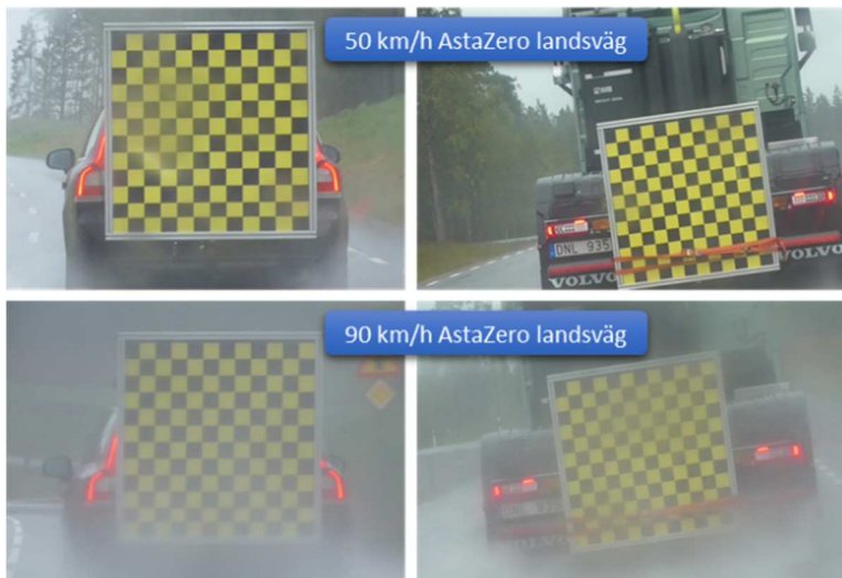
Figur 4 Filmerna och bilderna från provning på AstaZero visade tydligt att redan vid 50 km/h försämrades kontrastytan på Gridmodulen synbart. Vid 90 km/h kunde de värsta situationerna göra mönstret på Gridmodulen nära kontrastlöst.
