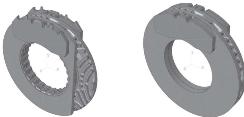
Figur 1. Vänster: Ingående komponenter i skrivbromsen. Höger: Ingående komponenter i skrivbromsen sett från ett simuleringsperspektiv där komponenternas geometrier är något förenklade
