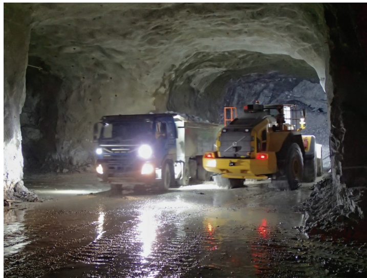
Figur 10. Bild över pågående lastning av bergbil i underjordsgruva.
