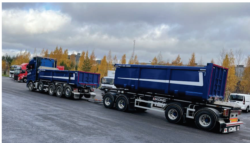
Figur 1. Femaxlig lastbil med fyraxligt kassetfflak (Foto: F Cederstav)
