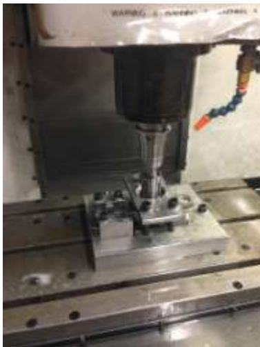
Fig 3. Behandling av Volvovipparm i standardmaskin med prototypverktyg
