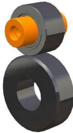
Fig 2. Kontakten mellan rulle och kamaxel i Halmstads kamföljarrigg
