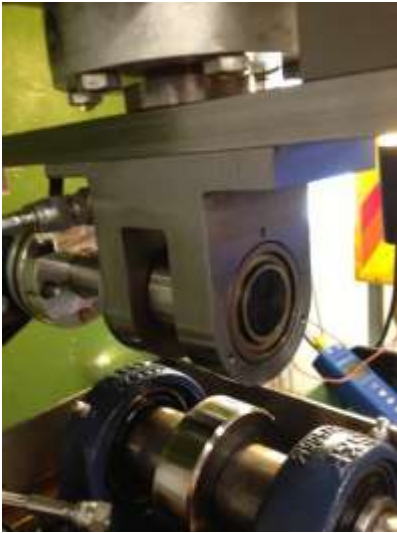
Fig 2. Kontakten mellan rulle och kamaxel i Halmstads kamföljarrigg
