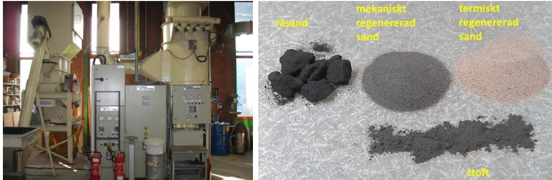
Bild 7. Exempel på utrustning för mekanisk rening av bentonitbunden gjuterisand (GEMCO) och på den reade sanden.
