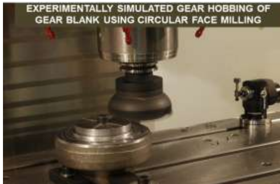
Figur 12 Bearbetningstest som efterliknar förhållanden vid konventionell hobbning.
