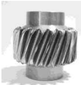
Experimentellt försök efter full 13 mm penetrering av verktyget i ämnet.
