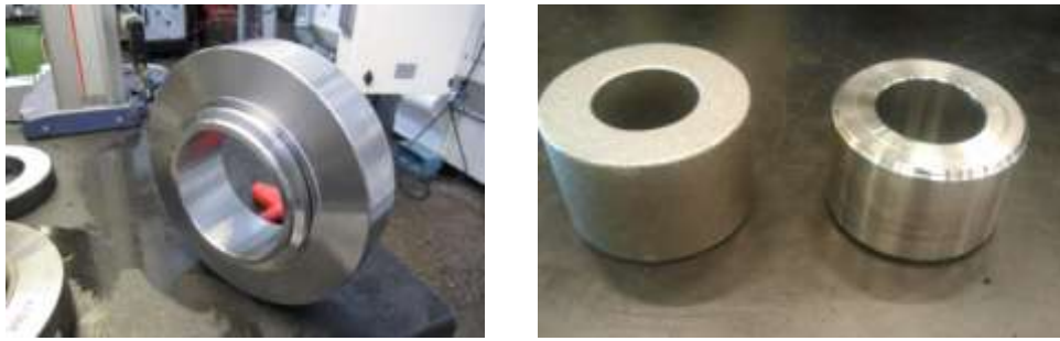
Figur 7 Scantias 2:a växel och och Volvos planethjul.
