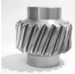
Experimentellt försök efter 6 mm penetrering av verktyget i ämnet.
