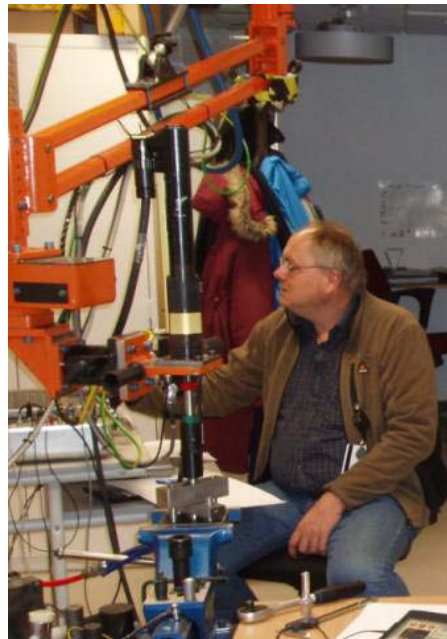
Figur 9. Provkroppsgeometri och fixtur (nederst i bilden till vänster) som användes vid åtdragning av skruvförbandet (höger).
