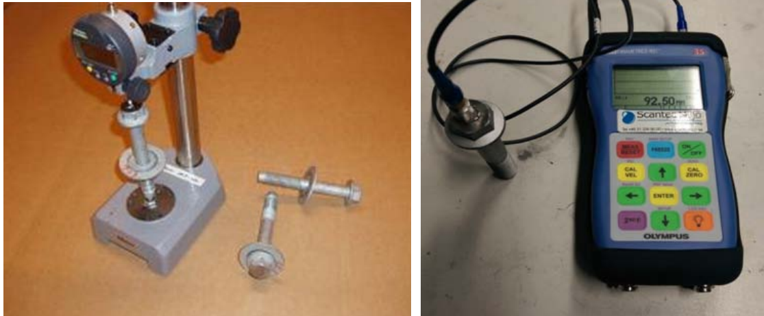
Figur 5. Utrustning för mekanisk längdmätning (vänster) och ultraljud (höger).
