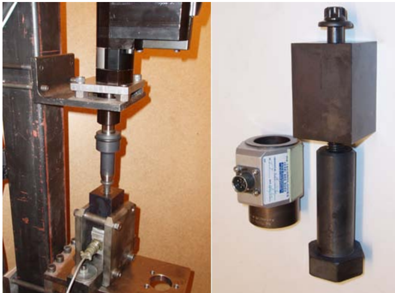
Figur 3. Atlas Copcos provrigg för utveckling av ultraljudsmontering.
