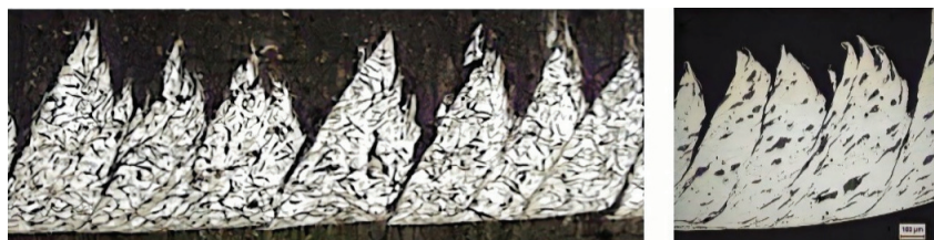
Figur 4: Spåna och segment från bearbetning av gråjärn med delvis öppen (t.v.) och sluten spånrot (t.h.), vilket ger olika förutsättningar för tillgång till omgivande atmosfär.
