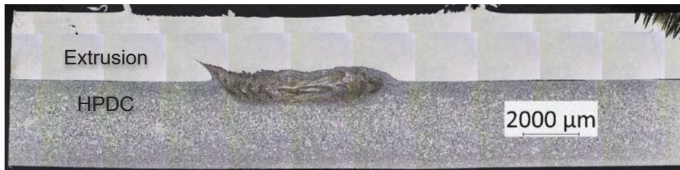
Figur 4 Svetsa tvärsnitt av extrudering till gjutning
