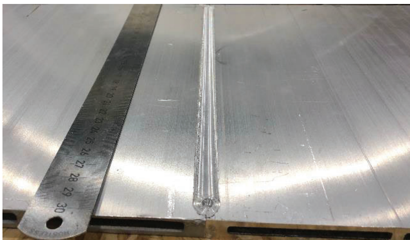
Figur 2 Demonstrator 2: FSW av extruderade profiler för tillverkning av en golvpanel till batterilådan
