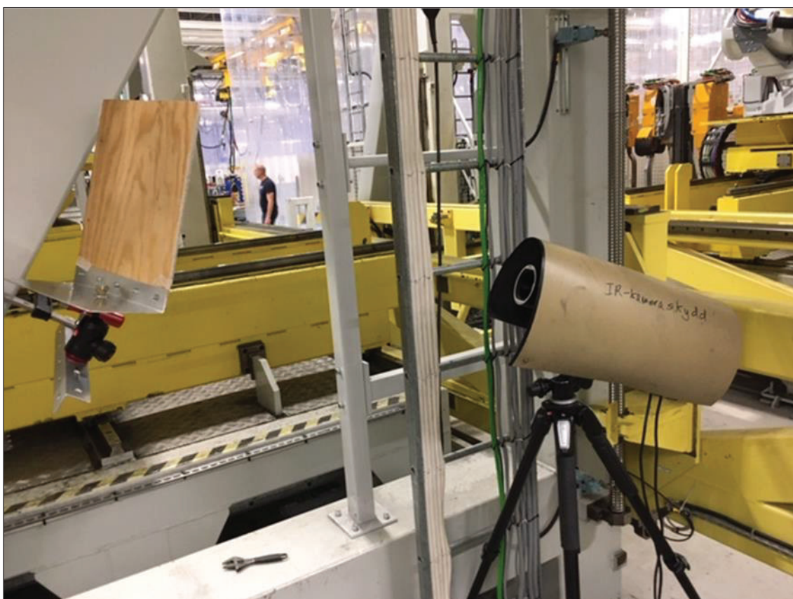
Figur 20. Uppställning av värmekamera vid svetsning av komponent för att undersöka hur temperaturen i komponenten påverkas av energitillförseln från svetsprocessen.
