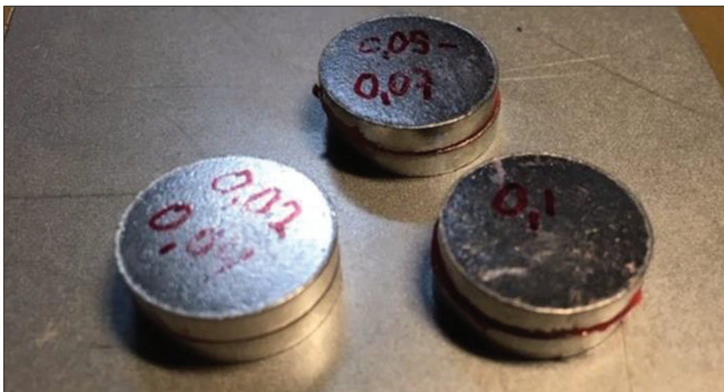
Figur 6. Visar provbitar från resistans och kapacitansmätningar av de olika limmerna, vid olika tjocklekar och temperaturer.
