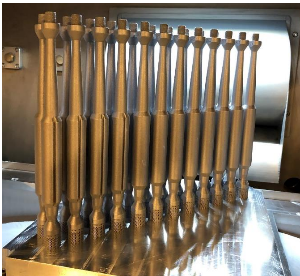
Bild 14. Tillverkningen har gjorts i en 3D Systems ProX DMP 320 maskin hos Lunds Universitet. Varje lager var 30 \mu\text{m} . Effekt varierade från 260 W till 300 W. Högsta hastighet 2000 mm/s.
