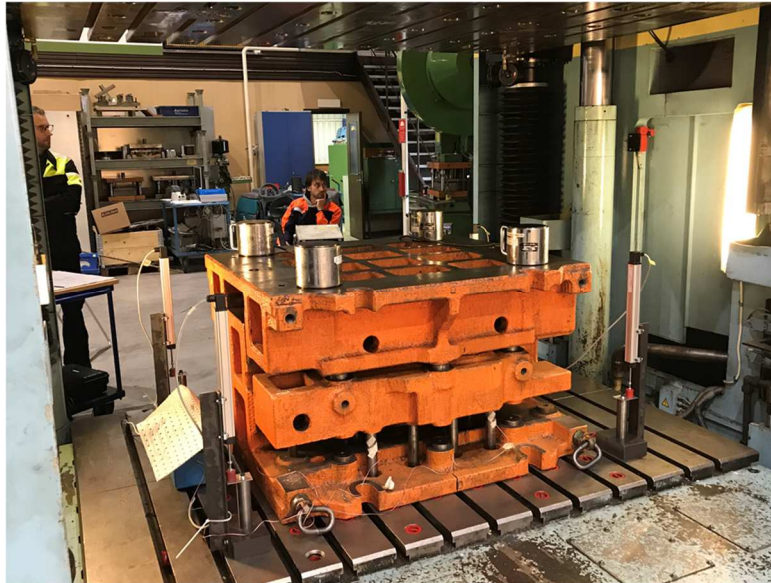
Figur: Mätning på press i Olofström, med lastceller på pelare.
