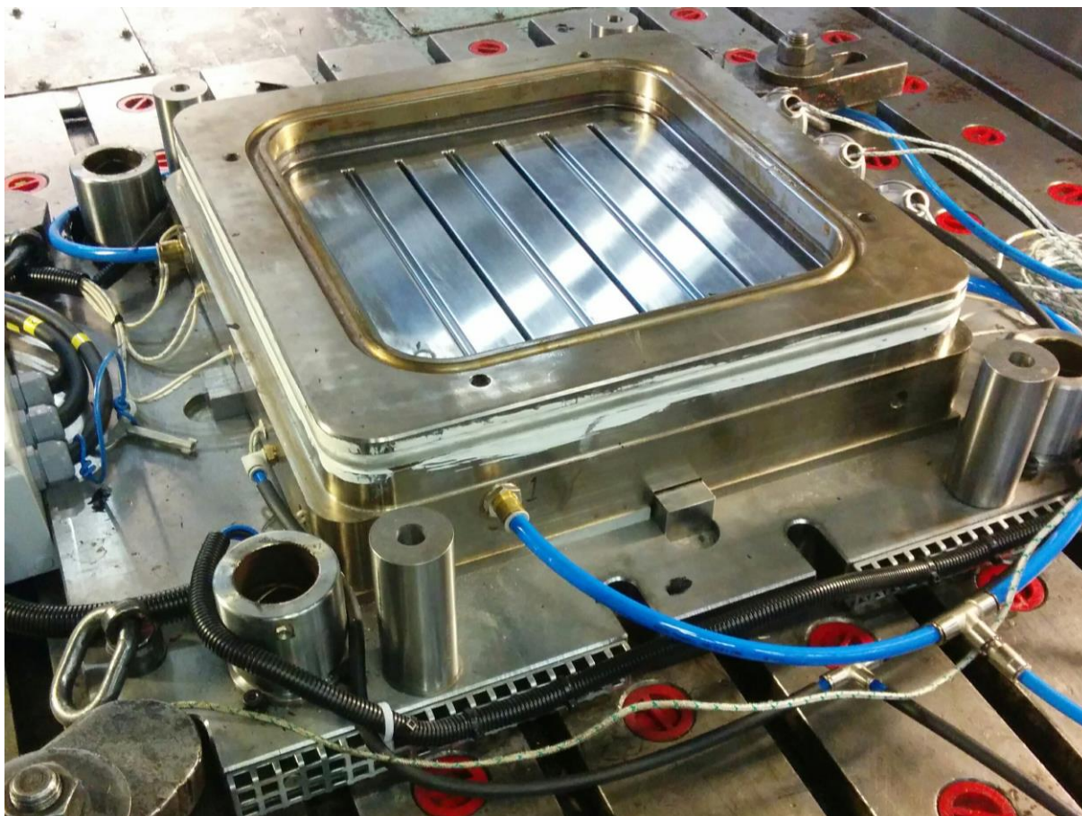
Figur 1 Provverktyg med geometri designad i SALLSA för att prova material, processparametrar och foglösningar.
