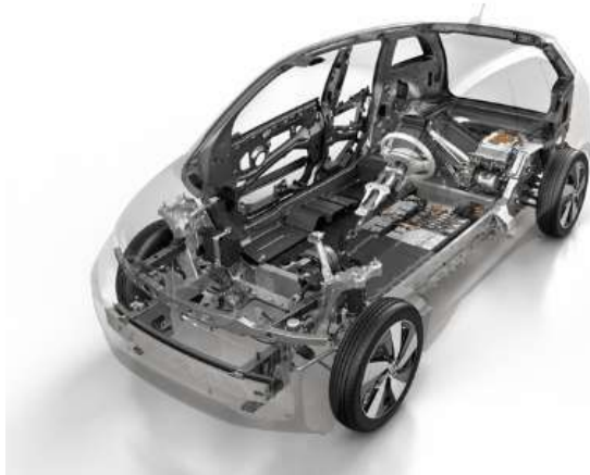
Fig. 1 Genomsnitt av BMW i3 med en komplett kompositkupé
