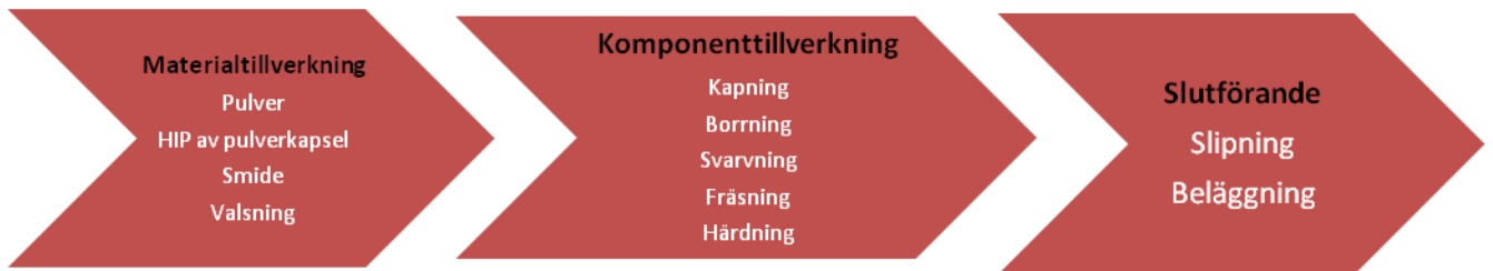
Figur 1. Traditionellt tillverkas en snäckfräs idag på detta sätt, från stålverket till färdig fräs.
