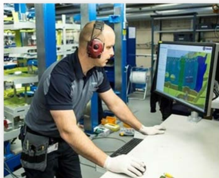
Figur 6: En operatör som arbetar med 3D-arbetsinstruktioner i SAABs verkstad
