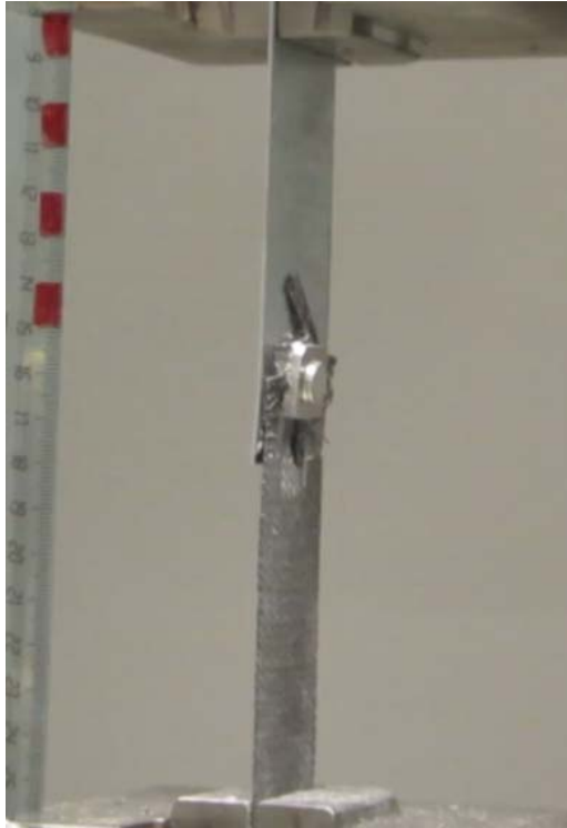
Bild 24: Kantigbricka och brickans storlek och dess påverkan på hållfastheten.
