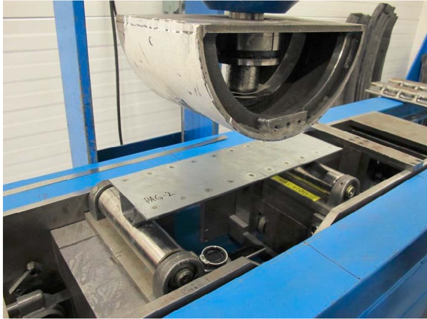
Bild 13: Försöksupställning av 3-punktstestning av hattprofil.
