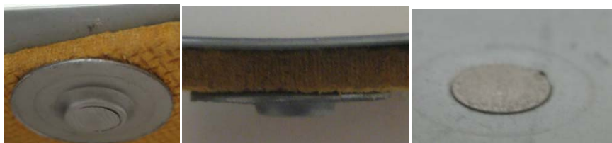
Bild 8: Principen för Pluggkonceptet. Här för ett stål Träförband.
