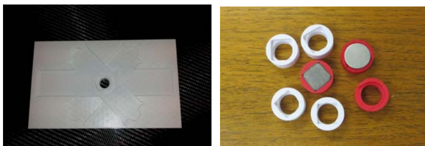
Bilder 10 och 11: Fixtur för skjuv och överlappsprov samt fixturer för runda och 4-kantiga pluggar.
