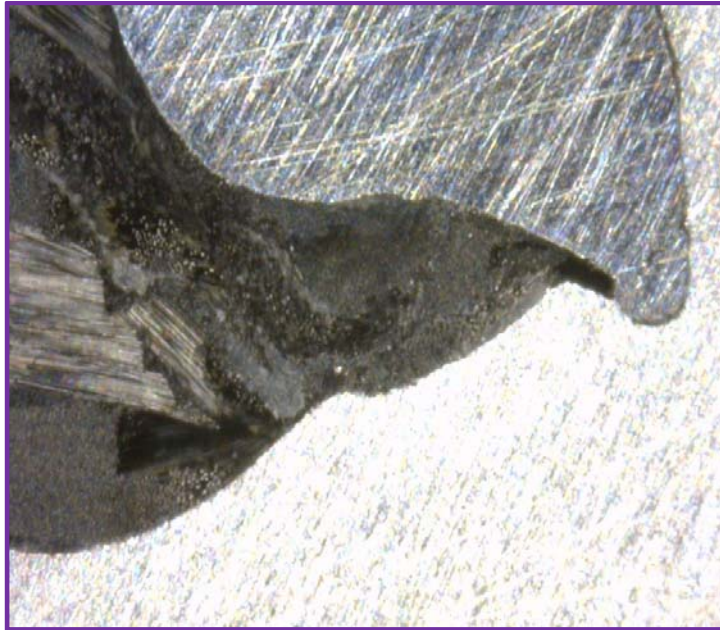
Bild 29: Krossad komposit i botten av nit/plugg-förbandet
