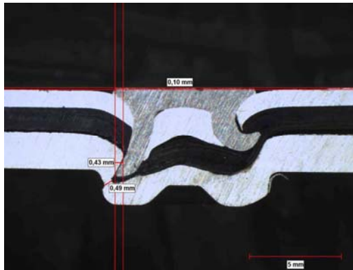
Bild 19: Nit som kantrar och skapar obefintlig låsning i pluggbrickan.
