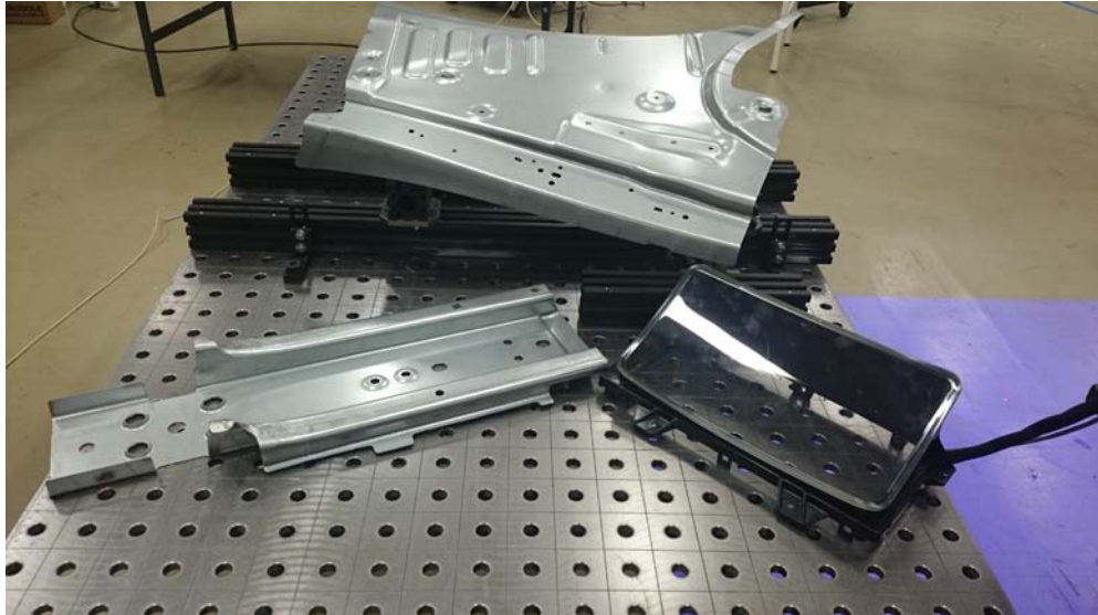
Bild 6. En inner skärm till VCC, en förstärkningsbalk från VLV och instrument hus med glas från KB Components.
