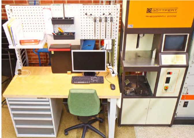
Bild 11: Kapillär-reometer 2002 från Göttfert GmbH som användes för reologisk mätningar
