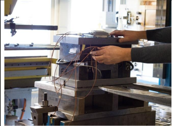
(a) Instrumenterat pressverktyg utvecklat för mätning av temperatur hos plåt och verktyg under formningen.
