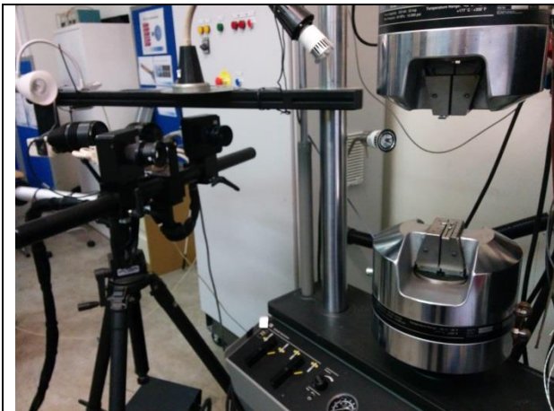
(a) Varmdragprovningssystem där Aramis töjningsmättningsapparat används för att utvärdera deformationsbeteendet vid förhöjd pressnings-temperatur, utvecklat vid IUC Olofström.
