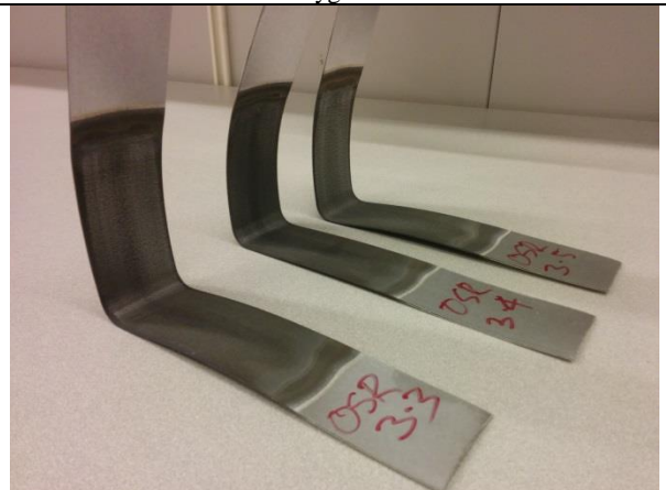
(d) Böjda och dragna Al-Si belagda borstålsremсор.
