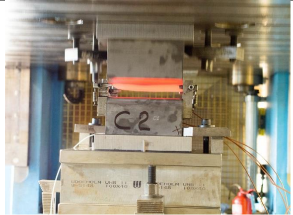
(b) Varmt borststålsämne under pressförsöken med experimentverktyg hos AP&T i Blidsberg
