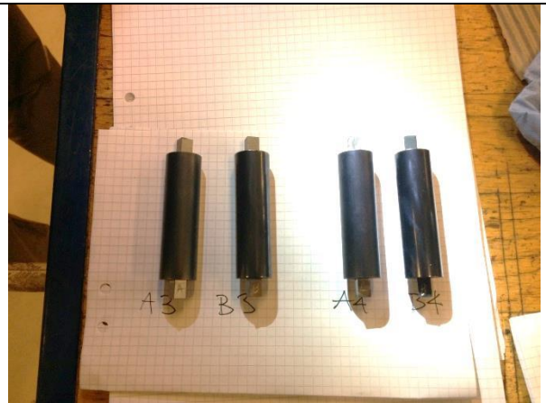
(b) PVD-belagda BUT verktygscylindrar tillverkade av AP&T och Oerlikon med verktygsmaterial från Uddeholm.
