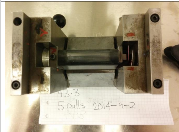
(c) Kontaktyta hos BUTpinne efter fem drag.
