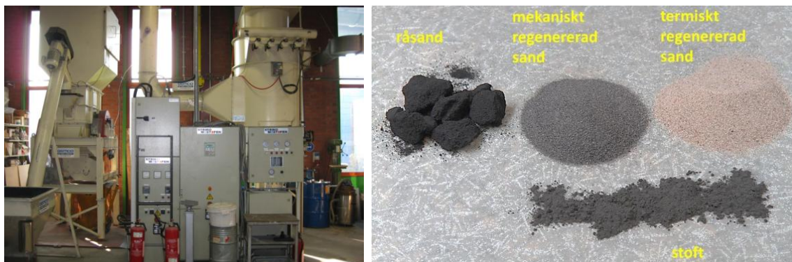
Bild 7. Exempel på utrustning för mekanisk rengöring av bentonitbunden gjuterisand (GEMCO) och på den reade sanden.
