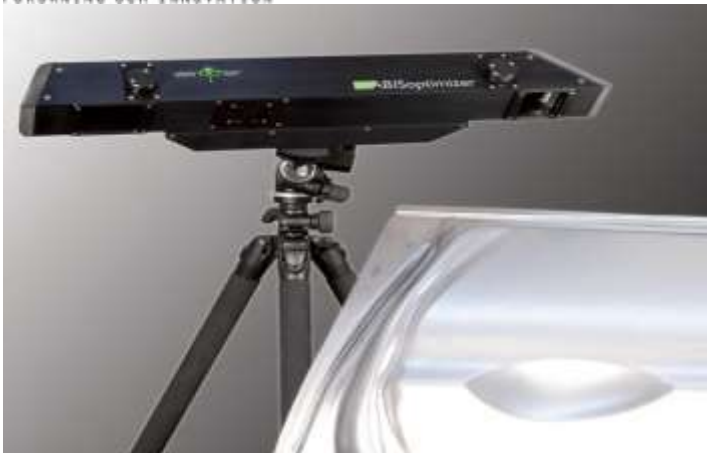
Figur . ABIS Optimizer för detektion och uppmätning av ytdefekter.
