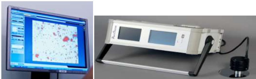
Figur . Partikelanalys med bildbehandling och partikelräknaren PartSens.
