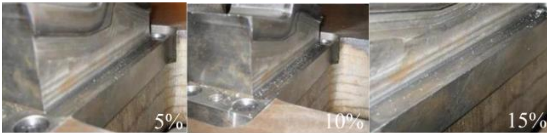
Figur 17 Exempel på resultat gällande bildande av flis och fnas vid klippning av aluminiumplåt med klippspalt på 5, 10 eller 15 % av plåtens tjocklek
