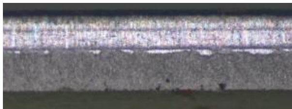
Figur 18 Exempel på resultat gällande kvalitet på den klippta kanten vid stansning av aluminiumplåt. Man kan även se fnas som har bildats och smetats fast i slutet av blankzonen
