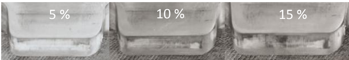
Figur 15 Exempel på resultat gällande påkladdning på klippegg vid klippning av aluminiumplåt med klippspalt på 5, 10 eller 15 % av plåtens tjocklek
