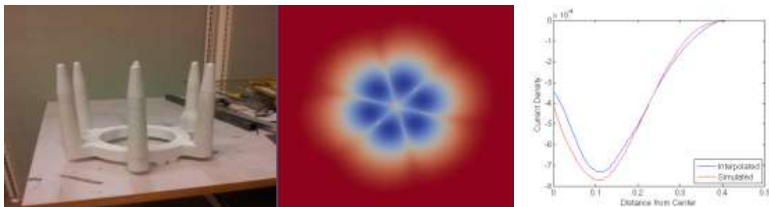
Figur 6. ABB G1 applikatoren med sex elektroder (vänster). Jonladdningsdensiteten mellan applikator och mål (mitten). En jämförelse mellan den simulerade och uppmätta strömdensiteten på en platta under applikatoren (höger).
