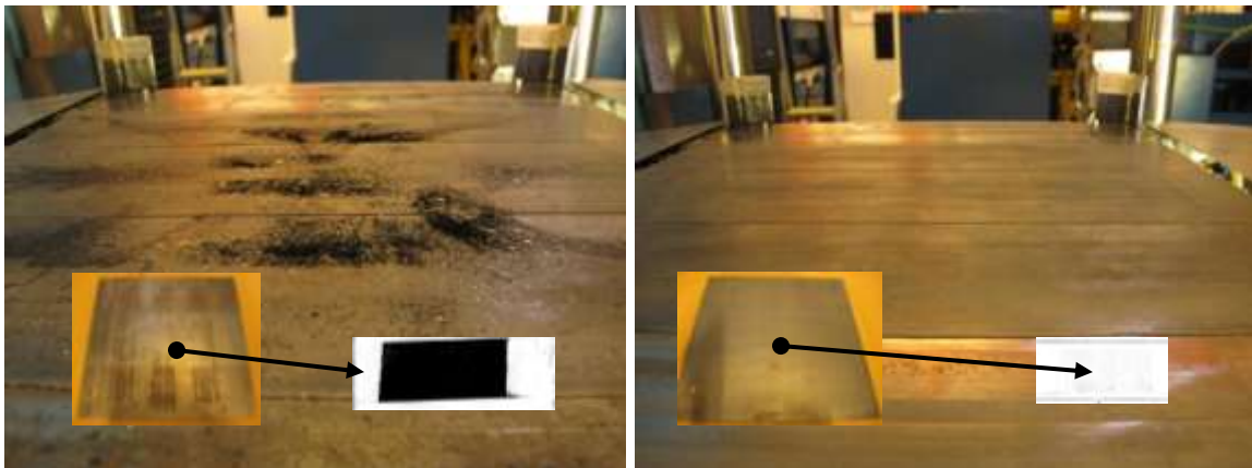
Figur 3. Presshårdning av icke förbehandlat referensmaterial (till vänster) och förbehandlat material (till höger) vars oxider uppvisar dålig respektive utmärkt vidhäftning. Bilderna visar verktygsytan efter presshårdning och den mängd oxid som flagat av från ämnena, samt de producerade plåtarna och respektive tejptest.
