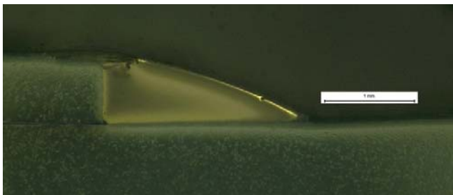
Bra resultat med Plasmatron i en rak överlappsfog
