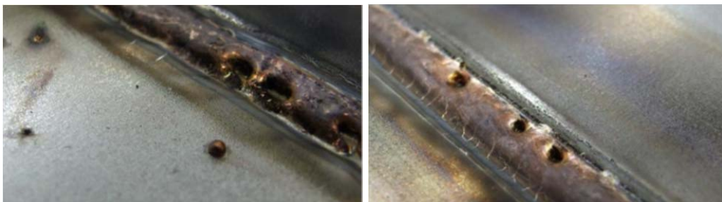
Exempel på typiska lödfel som porer, sprut och dålig anslutning mot över och underplåt (Källa J Wirth, EWM 2012)
