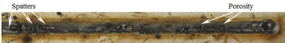
Laser svetsning av galvaniserat stål i en överlappsfog utan spalt som gett sprut och porbildning (J Ma et al. 2012)
