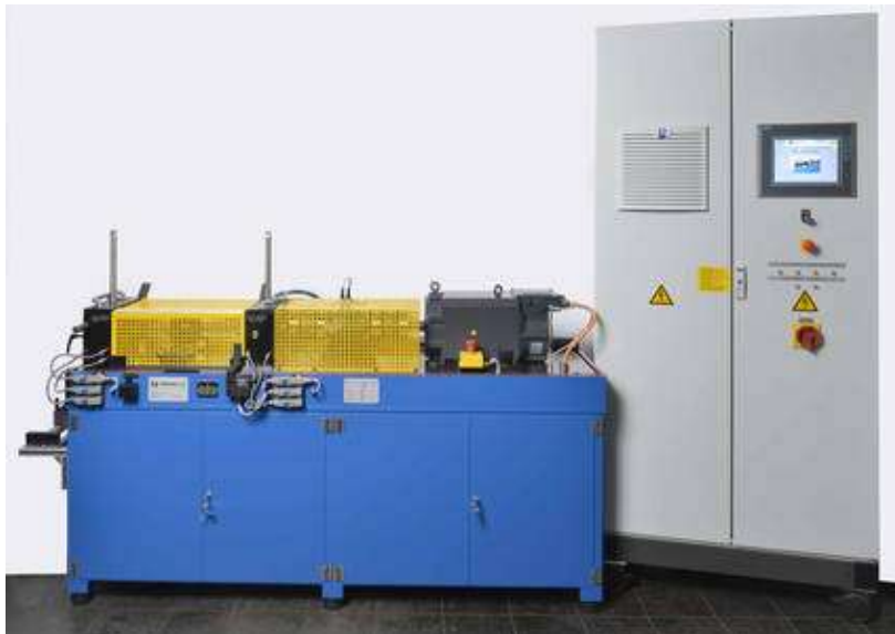
Bild 5. FZG-provmaskin för framtagning av S/N-kurvor.
