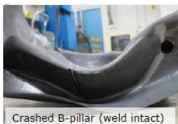
Figur 15 – Krockprovade B-stolpar (med AlSi-beläggning). Laser-hybridsvetsarna är intakta efter krockprovningen. Vänster bild: prov nr 13; Höger bild: prov nr 5. Båda är svetsade utan förstärkning.
