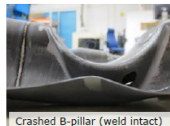
Figur 15 – Krockprovade B-stolpar (med AlSi-beläggning). Laser-hybridsvetsarna är intakta efter krockprovningen. Vänster bild: prov nr 13; Höger bild: prov nr 5. Båda är svetsade utan förstärkning.
