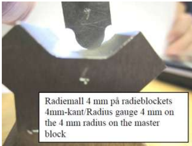
Figur 4 Radie-block, master för svets-tån
