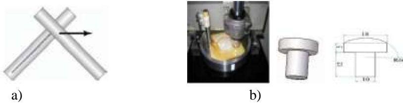
Bild 2 Använda utrustningar för slitageprovning: a) Tribological load scanner b) Pin-on-disk
