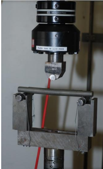
Bild 1 Experimentell uppsättning vid utmattningsprovning
