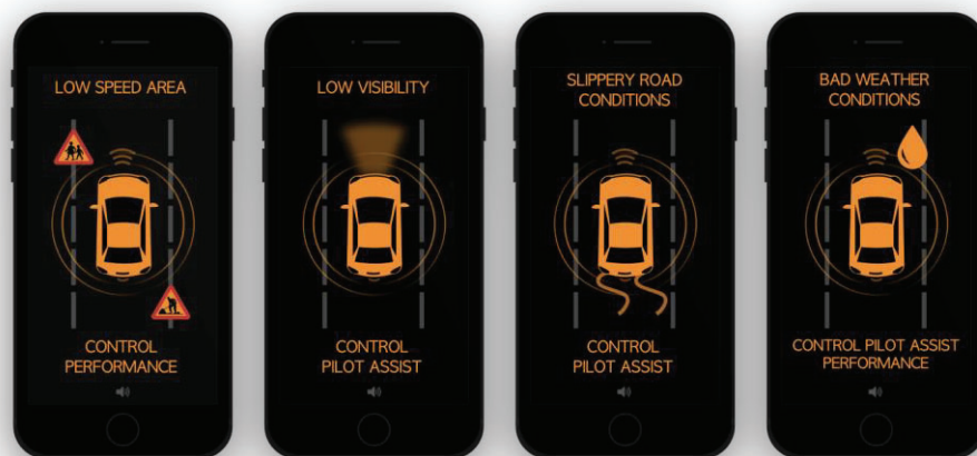
Figur 4. Varningar som visas för föraren när PA är aktiverat och ändringar sker i körkontexten som kan påverka prestandan på PA eller kräver högre uppmärksamhet av föraren.
