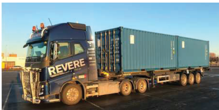
Figur 29. Testfordonet, en Volvo FH16 6x4 med semitrailer.
