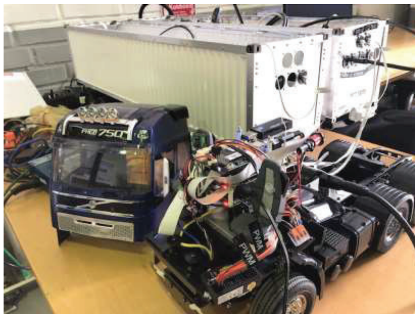
Figur 62. Dator i dragbilens hytt på skalmodellen.
