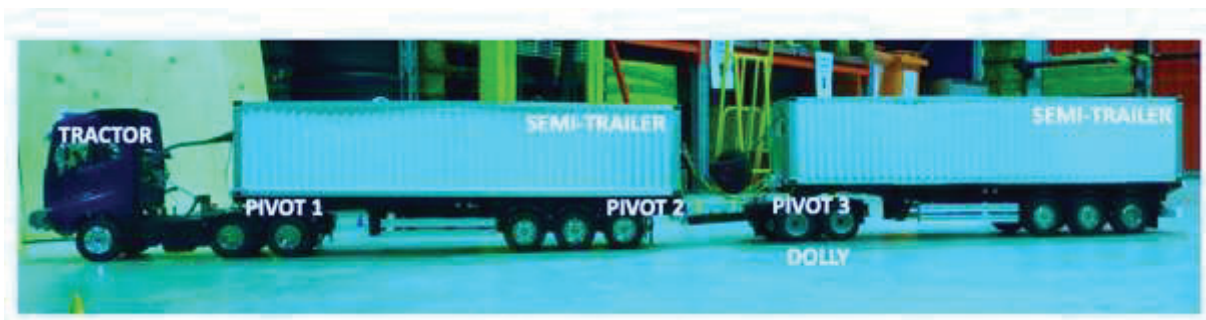
Figur 54. Skalmodellen som användes för rapid prototyping i labbet (Parshetti et al, 2021).
