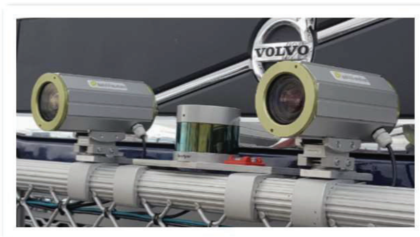
Figur 36. Kamerasystemet monterat på dragbilen (Combitech).
