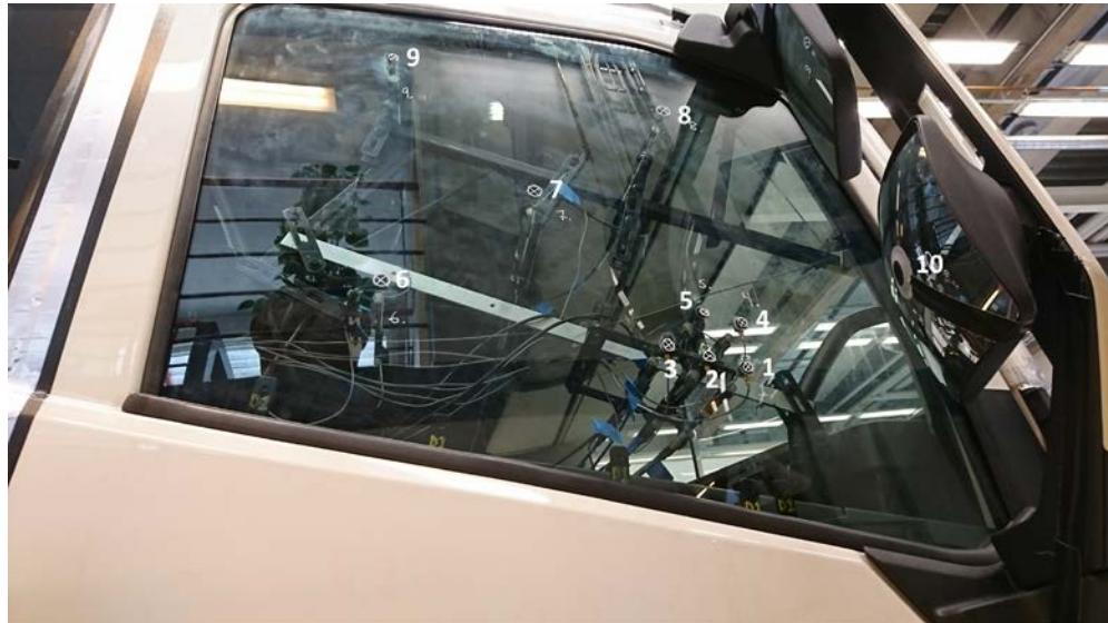
Figur 3. Mikrofonpositioner. Det är ett stort gitter (pos 1,6,7,8 & 9), samt ett mindre kring mikrofon 1 (pos 1, 2, 3, 4 & 5).
