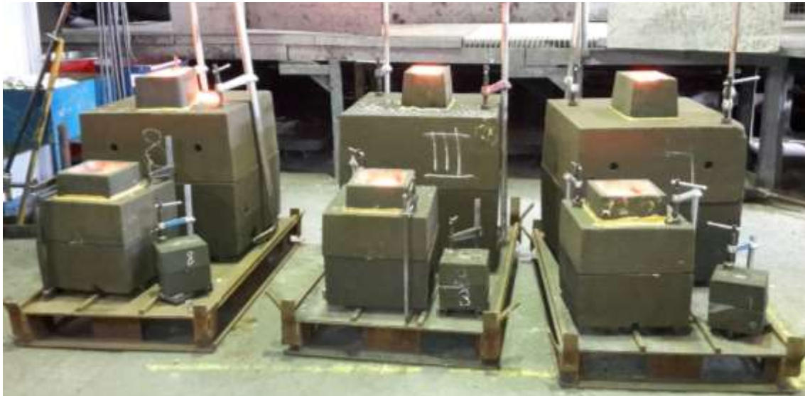
Figur 9. För varje uppsättning gjutparametrar göts 3 provkroppar vardera av 3 olika storlekar.
