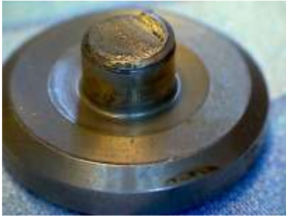
Skruvförband i den ursprungliga konstruktionen som utsatts för utmattningsbrott.
