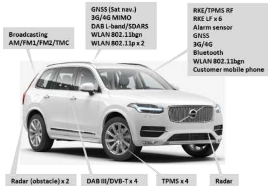
Figur 1. Exempel på radio och kommunikationssystem som används i ett modernt fordon idag eller i en nära framtid.
