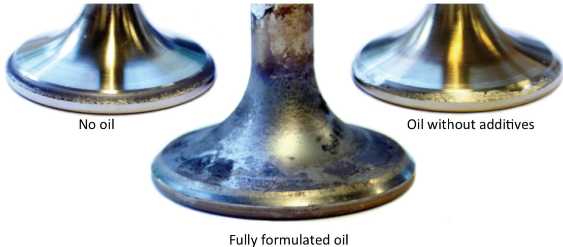
Fig. 3 Översiktsfoton av ventiler körda "tort" och med oljedimma flödande genom ventilen.
