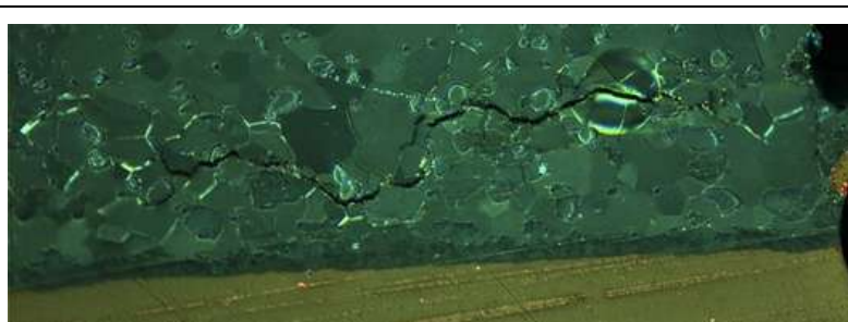
Figure 2. Exempel på sprickpropagering efter temperaturcyklning av BGA-komponent
