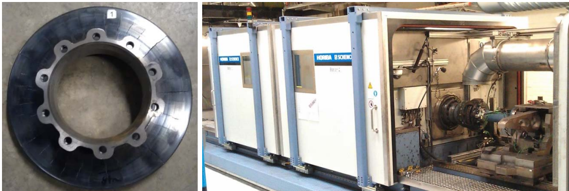
Figur 1. Till vänster ses en bromsskiva med kraftiga termiska sprickor och till höger ges en översiktsbild över en bromsdynamometer.
