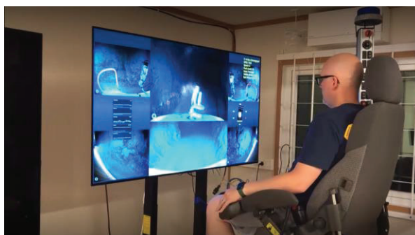
Figur 9, Konfiguration av skärmlayout efter tester
