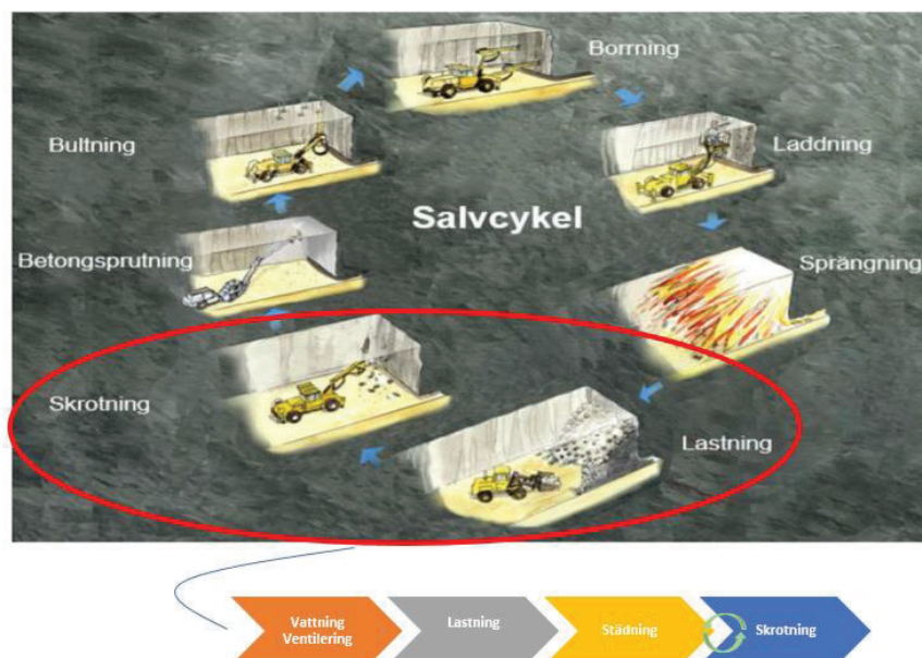
Figur 25 Vattning, lastning, skrotning samt transport av material är relevanta processteg för automatisering
