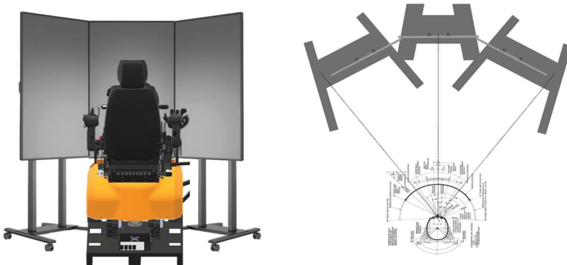
Figur 8 Fjärrstationens utformning vid leverans av systemet till gruvan
