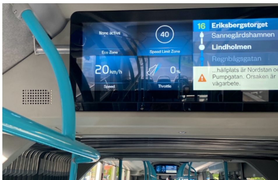
Bild 4 Foto från Consats pilot med samtidig visning av hastighetsbegränsad zon, aktuell hastighet och gaspådrag samt hållplatsinformation inklusive info om indragen hållplats.
