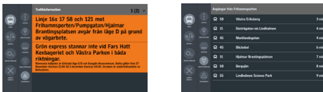
Bild 8 Samma information som visas i bild 7 kunde också visualiseras på chaufförens MADT (Multi Application Driver Terminal). Bilden visar två olika visningar.
