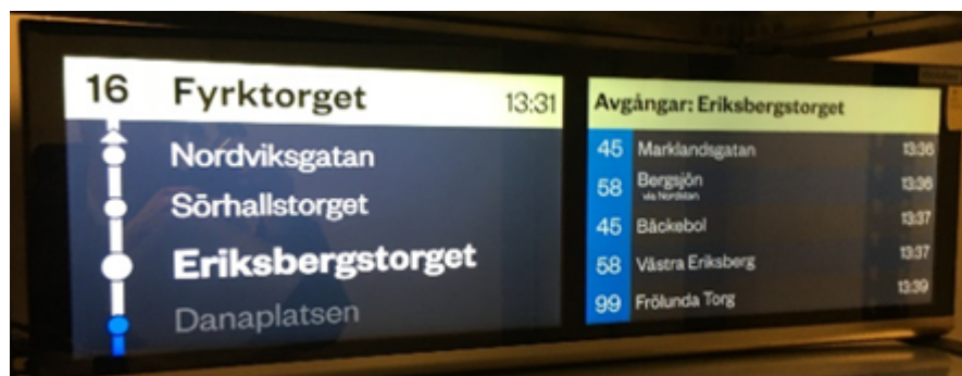
Bild 6 Luminators tjänst styr informationen på den inre skyltningen så resenären ser rutten samt bytesmöjligheterna vid nästa hållplats.
