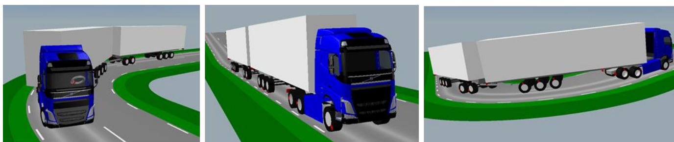
Figur 6.23. A-dubbel simuleringar: Från vänster till höger: 90 graders sväng. Backtagning. 90 graders sväng i lutning.
