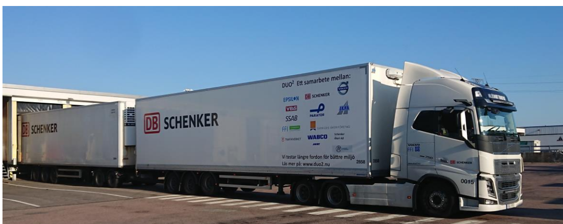
Figur 6.9. DUO-trailer, lastning av sista semi-trailern vid Schenker terminal i Bäckebo
