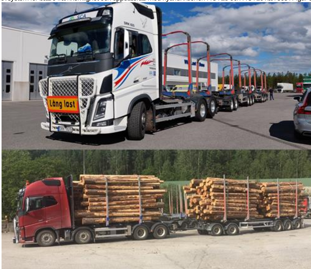
Figur 6.15. Övre: HCT1b pensioneras efter 1 096 795 km. Nedre: HCT1c i test körning som 24 meters 74 ton kombination hos Holger Nilssons åkeri.
