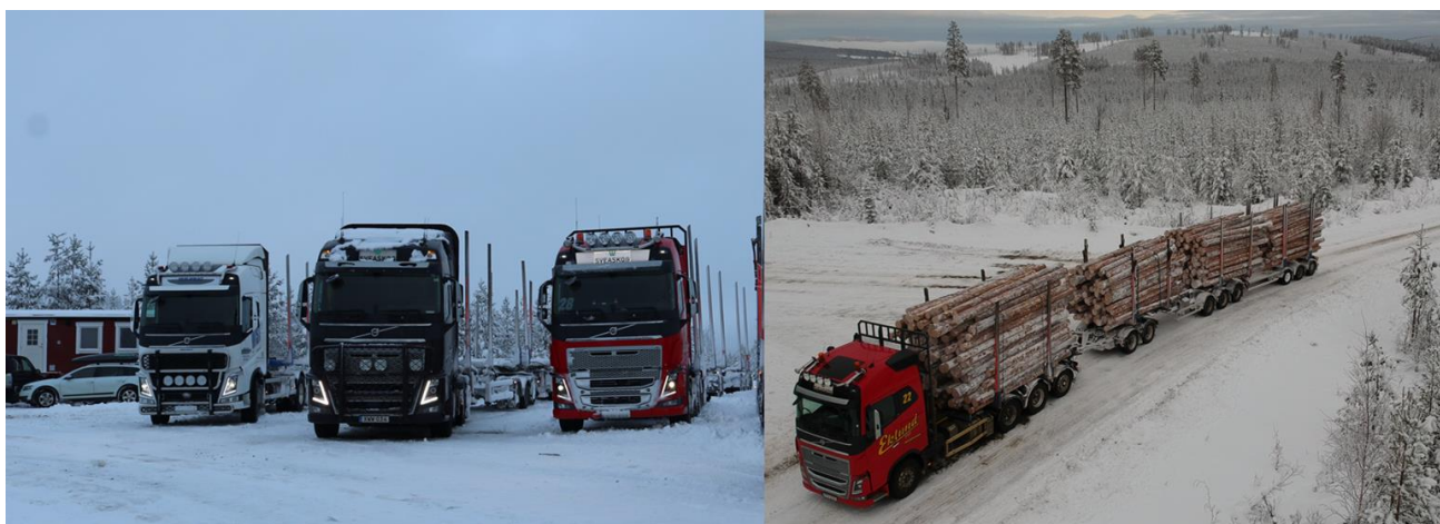
Figur 6.17. Från vänster till höger: Vit lastbil med fyraxligt släp (64ton). Mörkröd dragbil med link och semi-trailer (HCT16b 74 ton). Röd lastbil med femaxligt släp (74 ton). Röd lastbil med dolly link och semi-trailer (98 ton)
