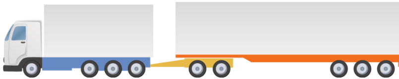
Figur 2. Försöksfordonet i nioaxligt utförande med en tillåten bruttovikt om 74 ton nederst i jämförelse med ett sjuaxligt 60(64)-tonsfordon överst.
